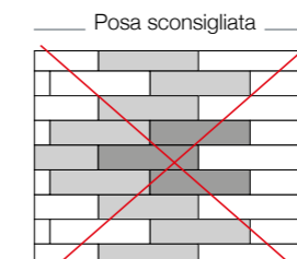
Non è consigliabile posare il materiale sfalsato di 1/2 (30 cm).
