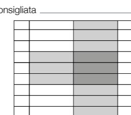
Per la posa ortogonale si consiglia di utilizzare una fuga di 2 mm.
