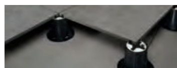
POSA SOPRAELEVATA DA ESTERNO Il sistema di pavimentazione sopraelevata prevede l'utilizzo di supporti portanti di tipo autolivellante, regolabili oppure fissi che si adattano con semplicità e sicurezza ad ogni tipo di pavimento sottostante. Il sistema permette la realizzazione di piani di posa con altezze variabili, da terra, comprese fra 25 e 270 mm. L'indipendenza della pavimentazione dai supporti garantisce l'assorbimento di eventuali movimenti strutturali. Il sistema sopraelevato non necessita di massetto in cemento e consente una diminuzione del peso sulla struttura portante. Le fughe aperte tra una piastrella ed un'altra consentono un facile deflusso dell'acqua piovana evitando tutti i rischi di accumulo o di ristagno. La presenza dell'intercapedine fra il piano di calpestio e il piano di appoggio favorisce l'aerazione e l'isolamento termico. Questa soluzione permette inoltre il passaggio di impianti e tubazioni nell'intercapedine, e la facile ispezione degli stessi una volta installata la pavimentazione. OUTDOOR RAISED LAYING SYSTEM The raised floor system foresees the use of self-levelling, adjustable or fixed load bearing supports that easily adapt to the floor below in total safety. The system is suitable to create laying designs with variable heights from the ground, which range between 25 and 270 mm. The independence of the flooring from the supports guarantees the absorption of any structural movements. The raised system does not require a cement screed and reduces the load on the bearing structure. The open joints between the tiles allow rainwater to easily drain off, avoiding any risk of water accumulation or stagnation. The gap between the tread surface and the support surface favours ventilation and heat insulation. This solution allows for the installation of systems and piping in the gap, which can be easily inspected even once the floor has been installed.
